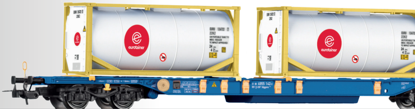
Doppeltragwagen Sdggmrs 744 der Eisenbahn Gesellschaft Potsdam mbH (EGP), beladen mit zwei 20' Tankcontainern und einem 40' Container
