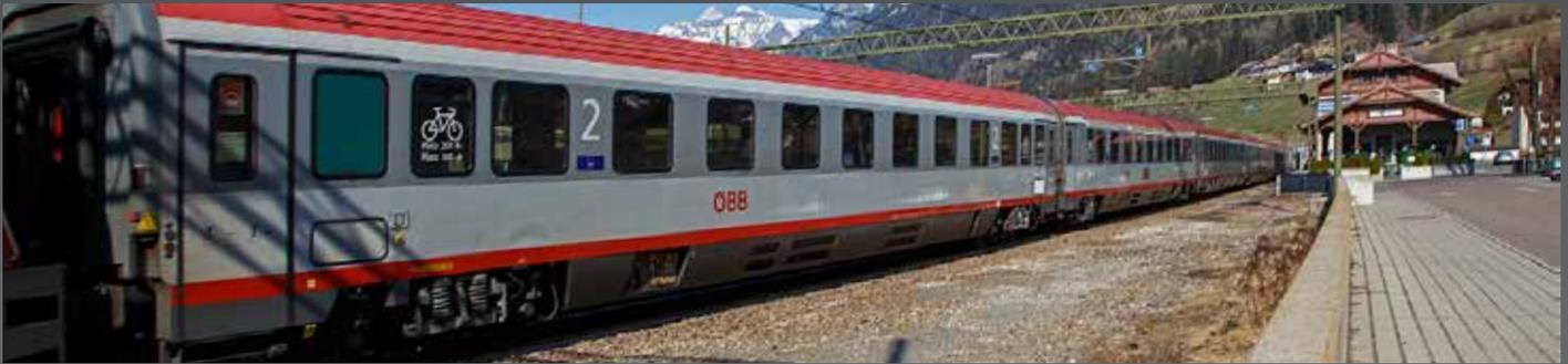
Ab 1989 beschaffte die ÖBB weitere druckertüchtigte Personenwagen der Bauart UIC-Z. Sie unterscheiden sich von der Eurofima-Ursprungsbauart durch die tiefergehende Schürze, fehlende Klappfenster, sowie an den Ecken liegende Schlussleuchten. Im Rahmen des Upgrade-Programms wurden die Wagen teilweise umgebaut und modernisiert und erhielten die
