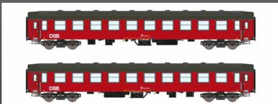
Ab 1971 wurden die Wagen in einer modernisierten Ausführung geliefert, ältere Wagen wurden entsprechend angeglichen: Die Einstiege erhielten 3 anstatt zuvor 2 Stufen, an den Stirnseiten wurden festinstallierte Rückleuchten eingebaut und die Zahl der Sitzplätze pro Abteil in der 2.Klasse wurde von acht auf sechs reduziert.
